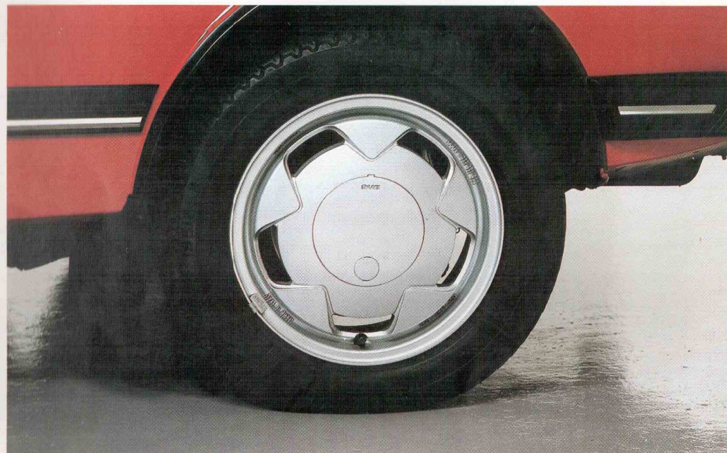
SILVER STAR, jonka sileä muotoilu on aerodynaamisesti oikeaoppinen, on Saabin kaikkien levypyörien tapaan omien tekniikkojemme testaama ja hyväksymä. Tässä pyörässä on irrotettava keskiökapseli, joka on saatavana myös lukittavana mallina.
