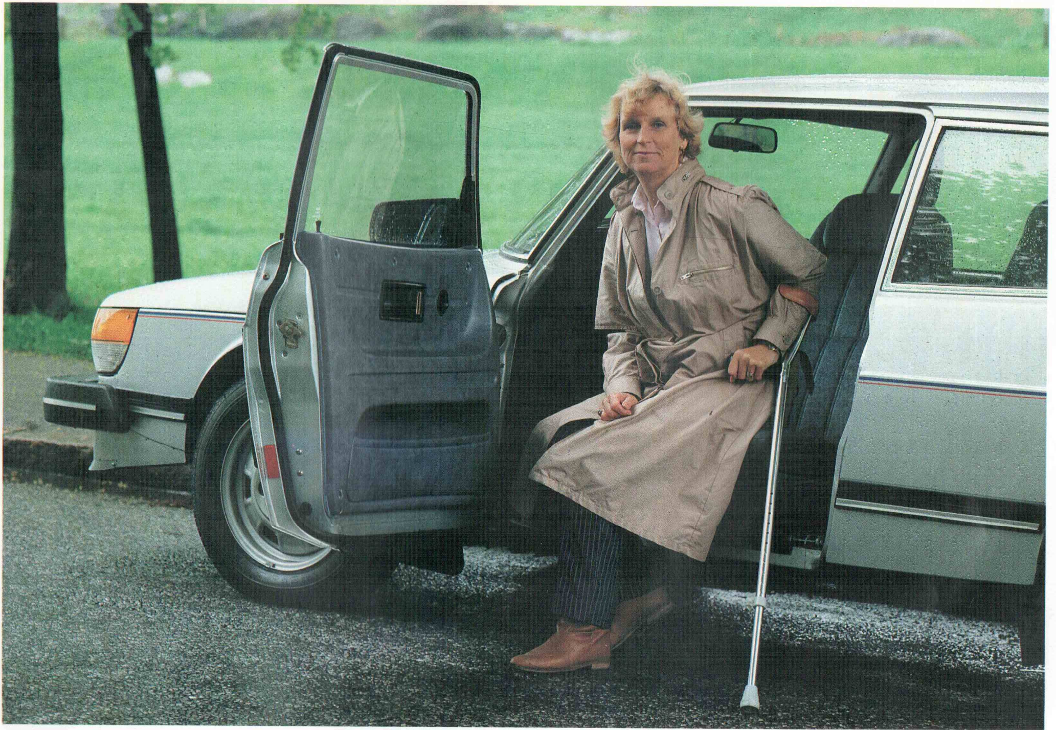
Etelstuinten tilalle voidaan asentaa kääntyvä istuin, joka yksinkertaisella kädenliikkeellä kääntyy 90 astetta. Tämä helpotta autoon tulemistä ja siitä poistumista. Verraton apuväline liikuntavammaille.
