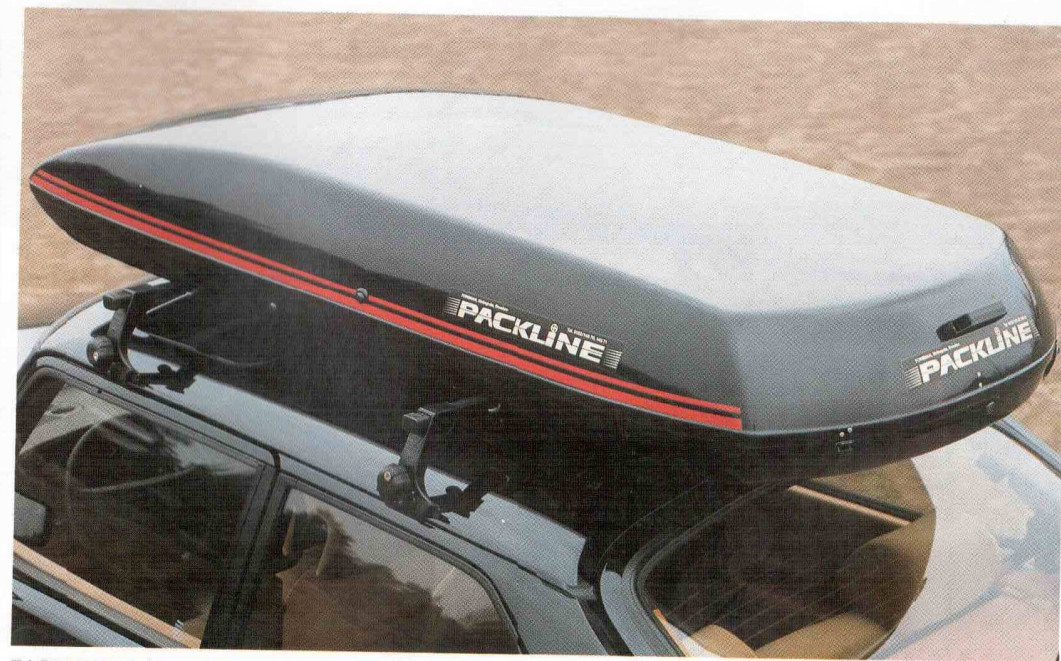
PACKLINE nielee melkein mitä tahansa. Saabin uusi tiiva tavarankuljetuslaatikko on valmistettu lasikuituvahvisteisesta muovista. Sitä valmistetaan kahta kokoa. Leveydet 60 ja 90 cm, pituus 220 cm ja syvyys 30 cm. Alansa huipputuote.
