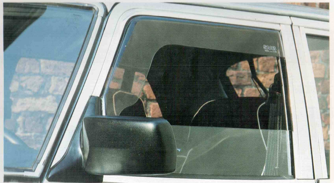
VISIIRI. Vähentää vetoa ajettaessa sivuikkuna auki. Estää sateen pääsyn autoon ikkunoiden ollessa hieman auki.
