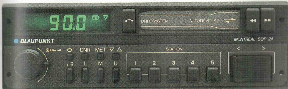
BLAUPUNKT MONTREAL SQR 24. Autostereo, jossa ULA, KA ja PA. Automaattinen asemanhaku ja 15 aseman pikavalinta. Kvartsiohjattu PLL-viritys. Kohinasuodatin sekä radio-että nauhuriassa. Nauhurissa mm. metallinauhakytkin ja automaattinen suunnanvaihto. Lähtöteho 2x10 W.
