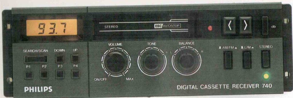
PHILIPS AC 740. Mikroprosessoriohjattu digitaalinen kvartziviritys. ULA, KA, PA. Elektroninen asemanhaku ja 4 aseman esiviritysmahdollisuus jokaisella aaltoalueella. Muistissa viimeksi kuultu asema. Valaistut näppäimet. Nauhuriassa Hard Permalloy-äänipää, kohinanvaimennin y.m. Lähtöteho 2x9 W.
