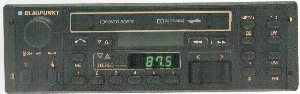
BLAUPUNKT TORONTO SQR 32. Korkealuokkainen autostereo täynnä digitaalitekniikkaa. Mikroprosessoriohjattu asemanhaku kumpaankin suuntaan. 12 ohjelmamuistipaikkaa. Nauhurissa mm. metallinauhakytkin, automaattinen suunnanvaihto. Erilliset basso- ja diskanttisäätimet. Lähtöteho 4x7 W.
