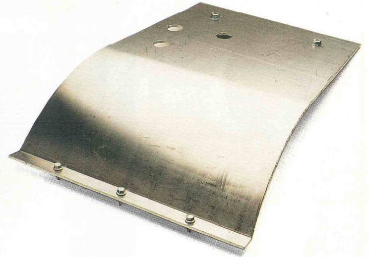
Pohjapanssari suojaa auton öljypohjaa. Se on tarpeellinen erittäin huonokuntoisilla teillä ja kilpailukäytössä.
