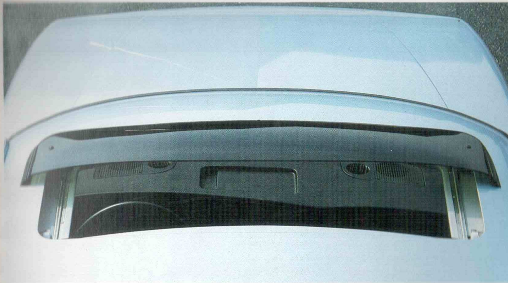
KATTOLUUKUN ILMA NOHJAIN, joka sopii kaikkiin Saab 99- ja 900-malleihin. Läpinäkyvä, vaaleaa akryyli-muovia. Saatavissa sinisenä, vihreänä tai savunharmaana.
