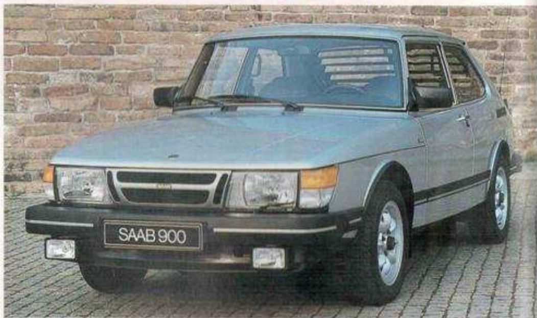
ETUVAKAAJA on kovaa, maalattavaa ABS-muovia. Se vähentää ilmanvastusta ja parantaa auton suuntavakavuutta. Puskurin alle on asennettu LISÄVALOT.
