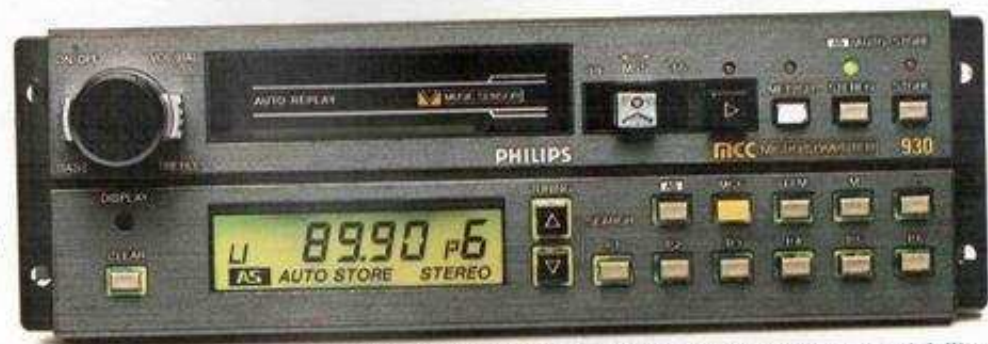
PHILIPS AC 930 AUTOSTEREOYHDISTELMÄ. Philipsin pitkälle kehitetty huippumalli. MCC mahdollistaa 10 aseman esivalinnan kuhunkin kuuteen MCC-kytkimeen. Mikroprosessori vertailee kaikkia 10 taajuutta ja valitsee automaattisesti voimakkaimman, joten matkan edetessä ei tarvitse hakea asemia. Uutuutena on Auto-Store-järjestelmä. A-S-kytkintä painettaessa tallentuvat paikkakunnan kuusi voimakkainta ULA-asemaa automaattisesti erillismuistiin vastaanottovoimakkuuden mukaisessa järjestyksessä. Nestekidenäyttö ja valaistut näppäimet.
