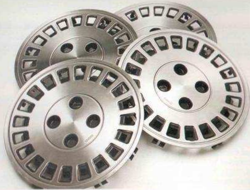
GLE-PYÖRÄKAPSELIT ovat ruostumatonta, kiillotettua terästä. Kiinnitetään helposti auton alkuperäisiin levypyöriin. Sopivat 5 1/2" vanteisiin M62 alkaen.
