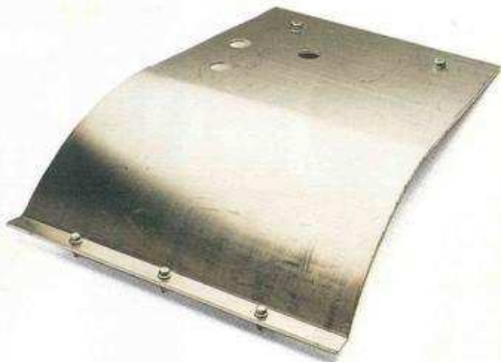
Pohjapanssari suojaa auton öljypohjaa. Se on tarpeellinen erittäin huonokuntoisilla teillä ja kilpailukäytössä.
