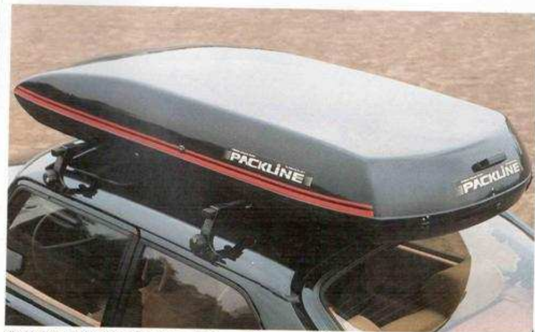
PACKLINE nielee melkein mitä tahansa. Saabin uusi tiiva tavarankuljetuslaatikko on valmistettu lasikuituvahvisteisista muovista. Sitä valmistetaan kahita kokoa. Leveydet 60 ja 90 cm, pituus 220 cm ja syvyys 30 cm. Alansa huipputuote.
