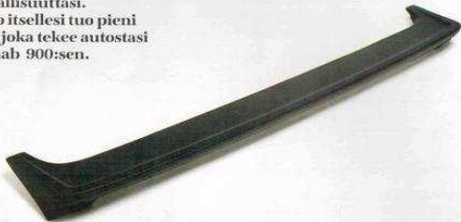
ETUVAKAAJA on kovaa, maalattavaa ABS-muovia. Se vähentää ilmanvastusta ja parantaa auton suuntavakavuutta. Puskurin alle on asennettu LISÄVALOT.
