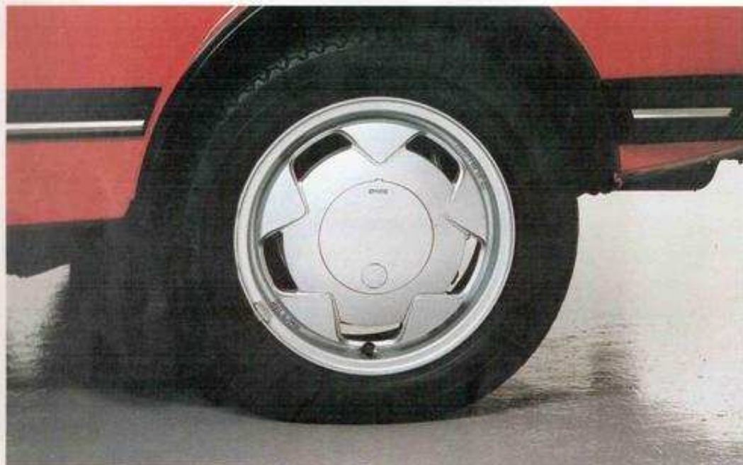
SILVER STAR, jonka sileä muotoilu on aerodynaamisesti oikeaoppinen, on Saabin kaikkien levypyörien tapaan omien teknikkojen me testaama ja hyväksymä. Tässä pyörässä on irrotettava keskiohkapseli, joka on saatavana myös lukittavana mallina.
