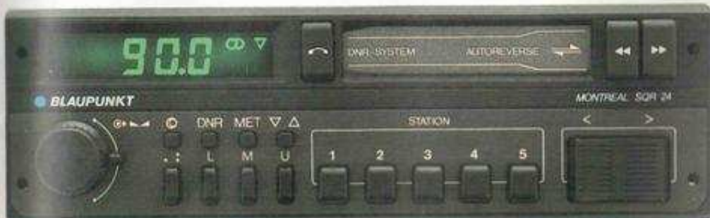
BLAUPUNKT MONTREAL SQR 24. Autostereo, jossa ULA, KA ja PA. Automaattinen asemanhaku ja 15 aseman pikavalinta. Kvartsiohjattu PLL-viritys. Kohinasuodatin sekä radio-että nauhuriassa. Nauhuriassa mm. metallinauhakytin ja automaattinen suunnanvaihto. Lähtöteho 2 x 10 W.
